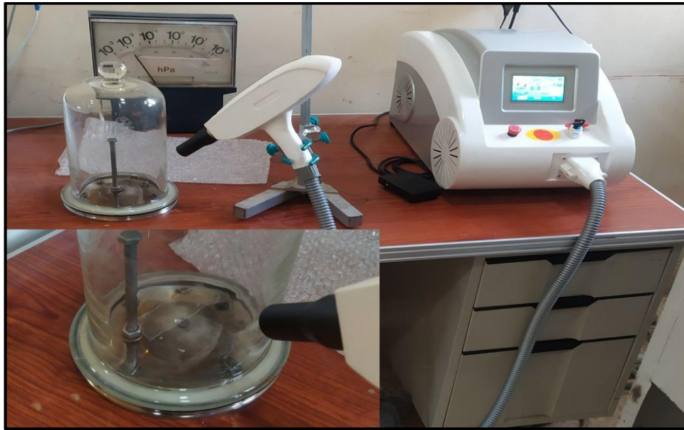
الشكل 3: مخطط لحجرة الترسيب وجهاز الليزر المستخدم في ترسيب الأغشية.
