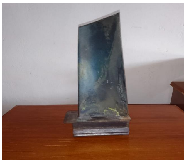
الشكل 1: الريشة التوربينية قبل التقطيع وقبل الطلاء.
