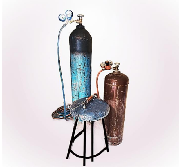
الشكل 2: جهاز الرش الحراري باللهب المستخدم.
